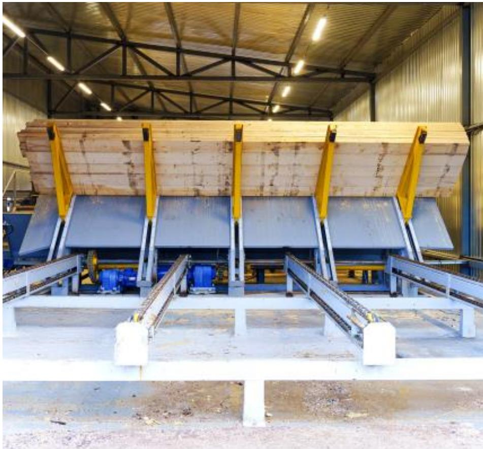
Транспортер устанавливается в начале линии для подачи пакетов в цех или в конце линии, для вывода готовых пакетов из цеха.
