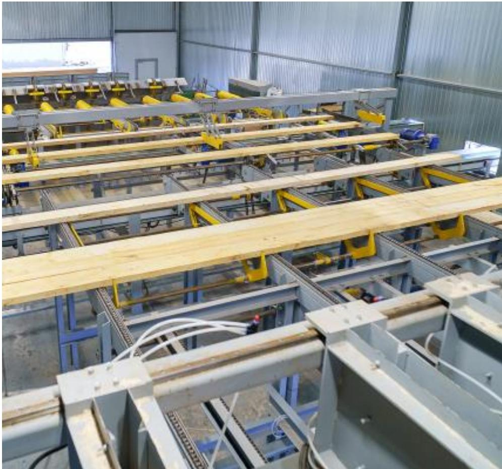
Транспортер при помощи ограничителей с пневматическим приводом, поштучно выдает пиломатериал. Устанавливается перед торцовкой проходного типа, разгонным модулем или перед пакето-формирующей машиной.
