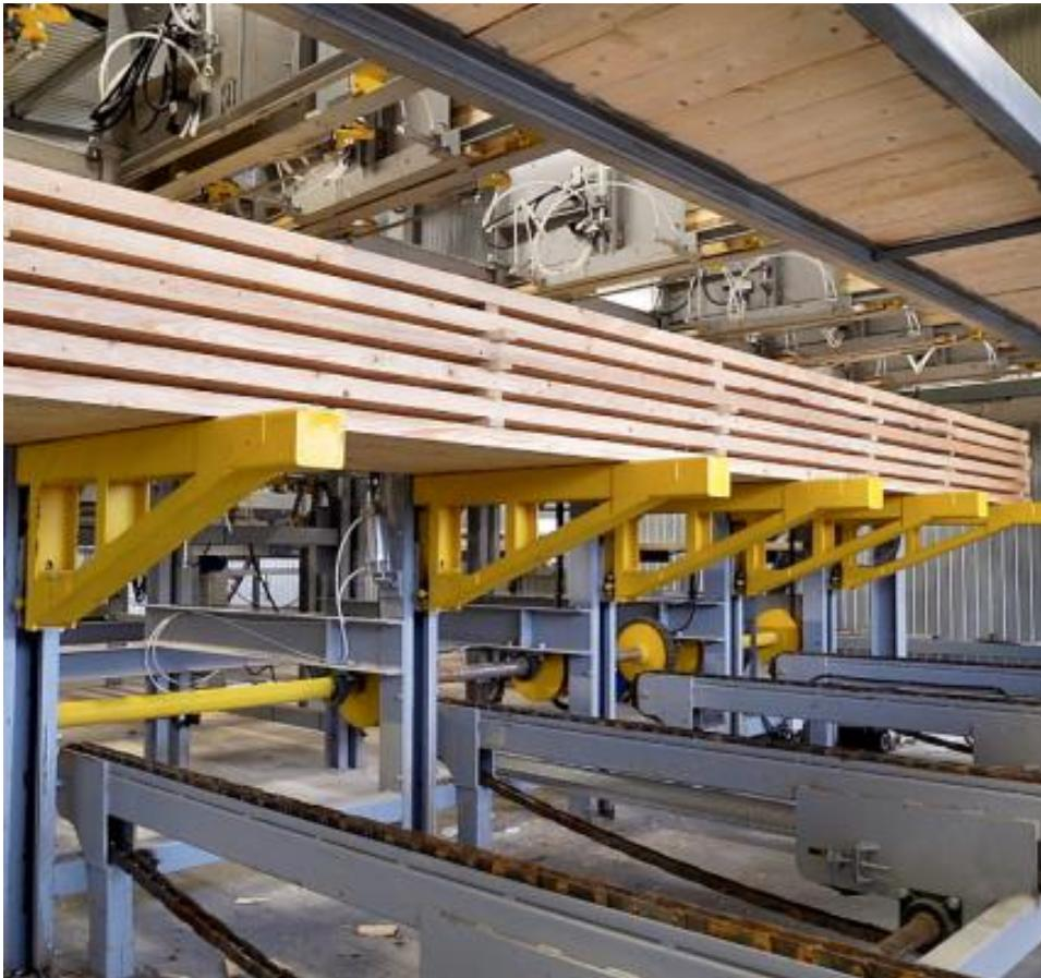
Пакето-формирующая машина послойно наполняет пакет пиломатериала, поднимает при помощи приводных кареток и отводит на транспортер готовый пакет.
