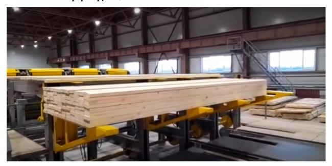
Пакето-формирующая машина послойно наполняет пакет пиломатериала, поднимает при помощи приводных кареток и отводит на транспортер готовый пакет.
