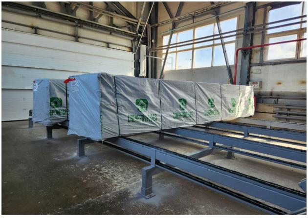
Транспортер устанавливается в начале линии для подачи пакетов в цех или в конце линии, для вывода готовых пакетов из цеха.
