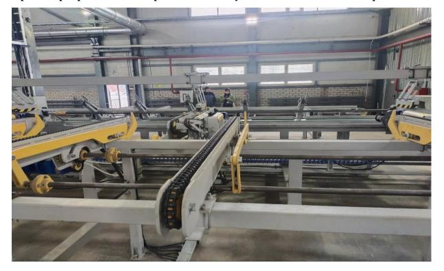
Транспортер при помощи ограничителей с пневматическим приводом, поштучно выдает пиломатериал. Устанавливается перед торцовкой проходного типа, разгонным модулем или перед пакето-формирующей машиной.
